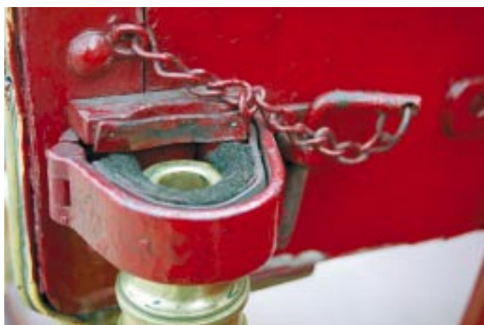
0489 - horní objímka úchytu proudnice je vyložena plyšovým pouzdrům
