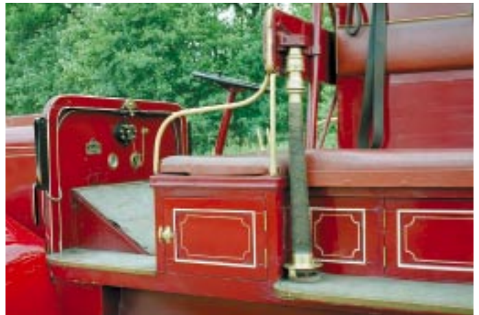
0490 - přepravní uložení proudnice na vozidle s kolmou stěnou přístrojové desky
