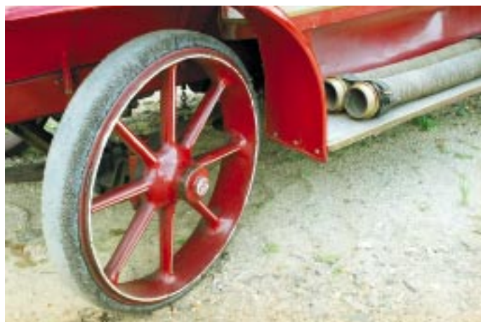
0488 - litá paprsková kola s původní plnopryžovou obručí
