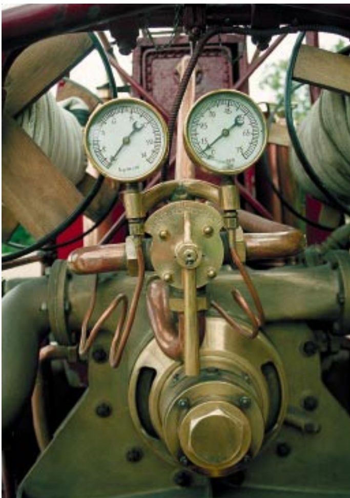
0490 - třícestný kohout ovládání čerpadla s manometry sání a výtlaku
