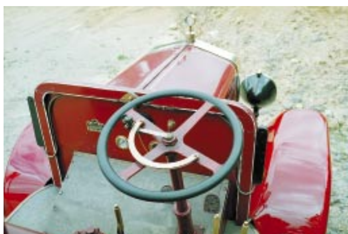
0490 - volant s pákou ručního plynu
