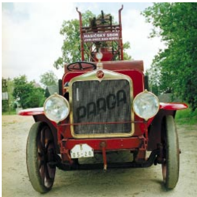
0489 - mohutný chladič tvoří předek vozidla
