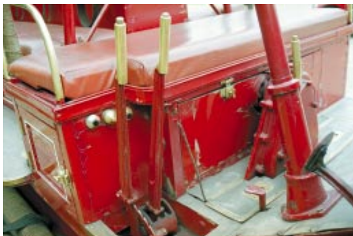
0489 - detail páky ruční brzdy, řadící páky a lanové ovládní horské vzpěry
