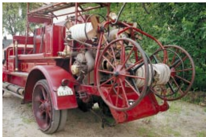
0488 - kovový závěsný naviják hadic skrývá mohutné čerpadlo vozidla
