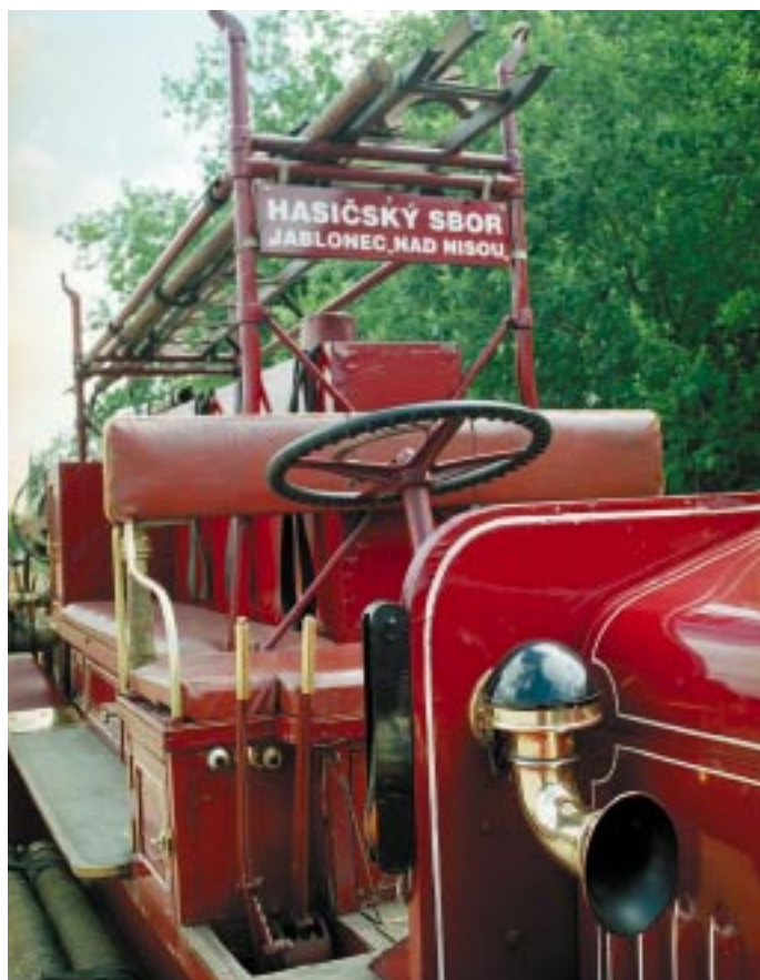
0490 - elektrická houkačka BOSCH, výkyvná boční směrovka, řadící páka a páka ruční brzdy
