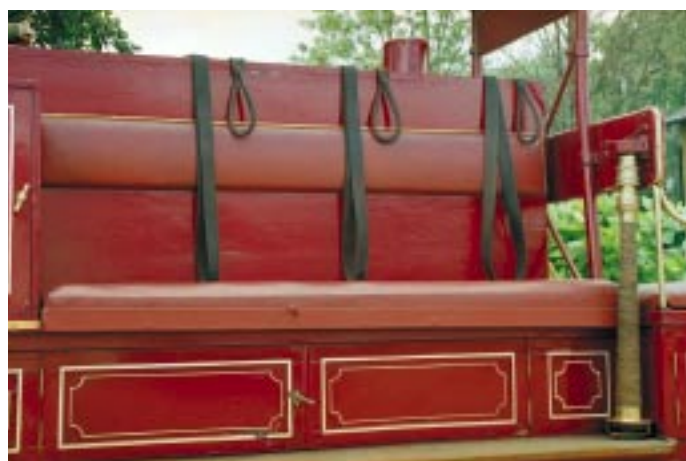
0489 - dřevěné sedačky jsou vybaveny koženou opěrkou a bezpečnostními pásy
