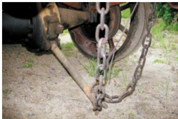
0489 - horská vzpěra sloužící k zajištění vozidla v příkrém svahu
