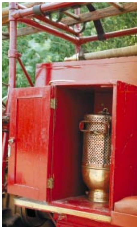
0490 - v jedné ze zakrytých skříňek vozidla je umístěn mohutný sací koš
