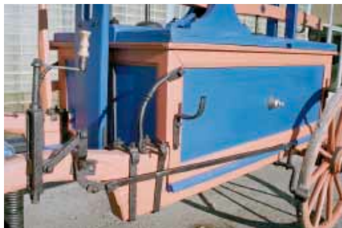
Pákový převod ruční brzdy na zadní nápravu stříkačky.
