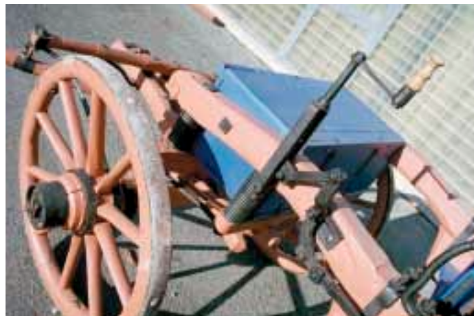
Kolmo uložené otočné páky ruční brzdy.
