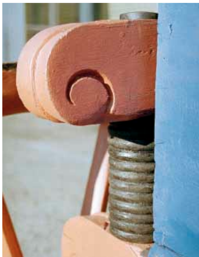
Vzpěra pro zachycení mohutných nosníků vany stříkačky.
