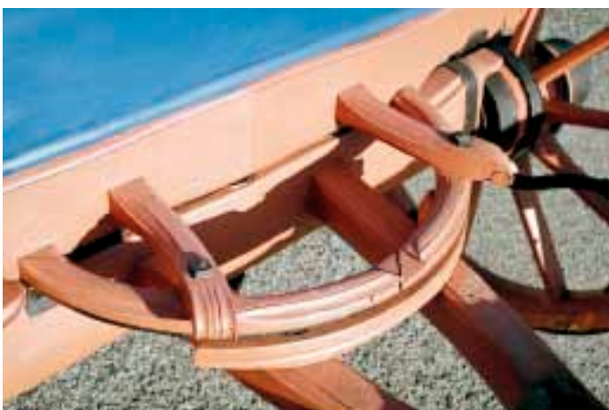
Detail provedení přední otočné nápravy stříkačky.
