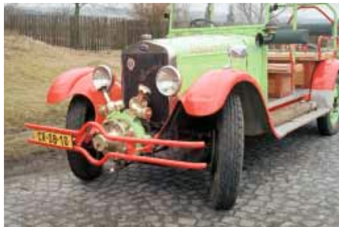
Vodní čerpadlo umístěné vpředu na rámu vozidla chráněné trubkovým nárazníkem.
