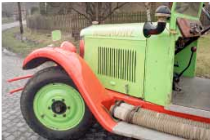
Uložení savic na stupáku autostříkačky, kapotáž motoru a elektrická siréna.
