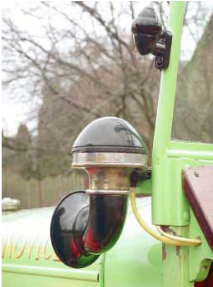
Detail elektrické sirény a boční směrový blikáč vozidla.
