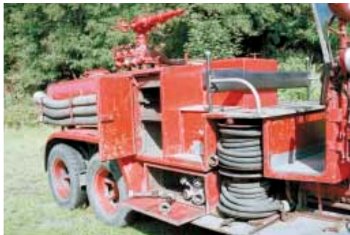
Boční stěny vozidla tvoří skříňky pro uložení hadic a další nezbytné výbroje.
