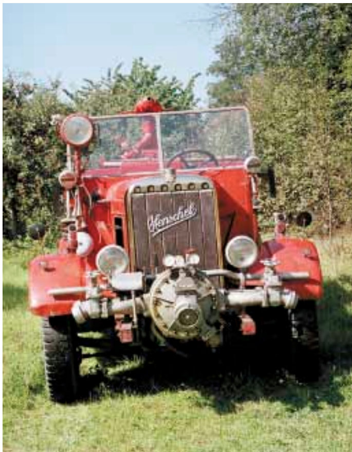
Přední části vozu vévodí mohutné čerpadlo.
