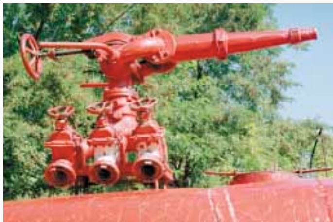
Otočné dělo není z původní výbroje vozidla (bylo členy sboru vmontováno dodatečně).
