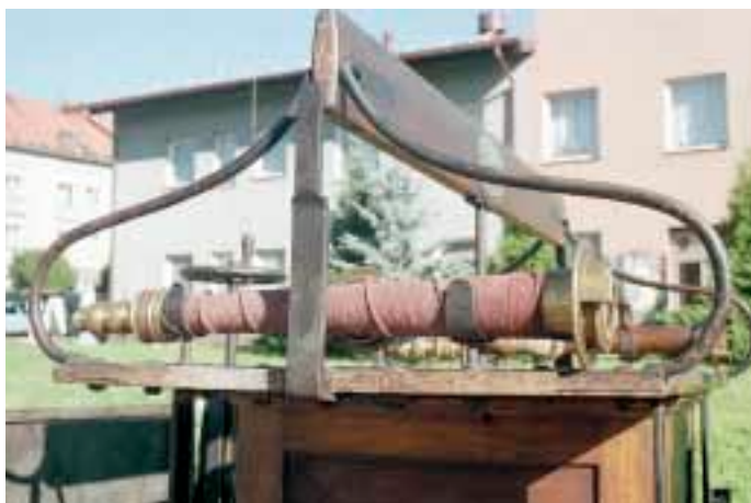
Kozlík stříkačky s proudnicí v přepravní poloze.
