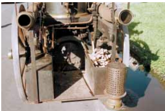
Parní kotel s uloženými savicemi a sacím košem v přepravní poloze.
