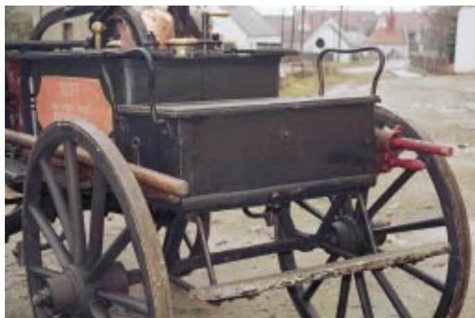
0489 - zadní sedačka stříkačky s úložným prostorem pro příslušenství a nářadí stříkačky
