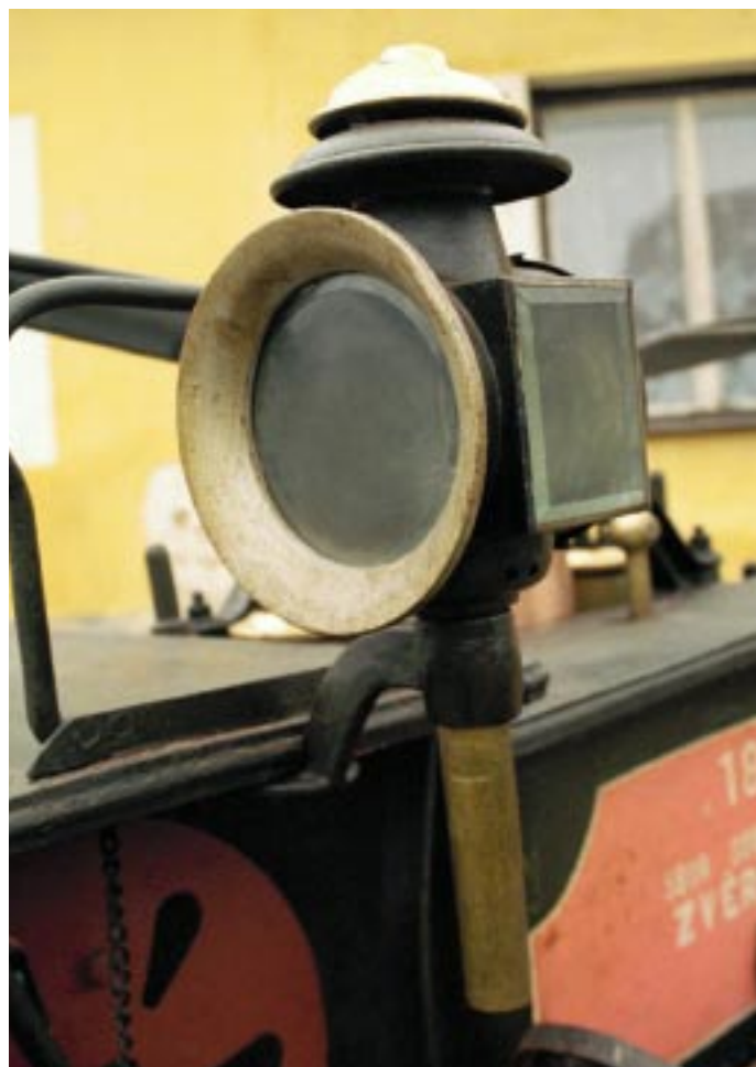
0489 - přenosná svítilna a její umístění na stříkačce
