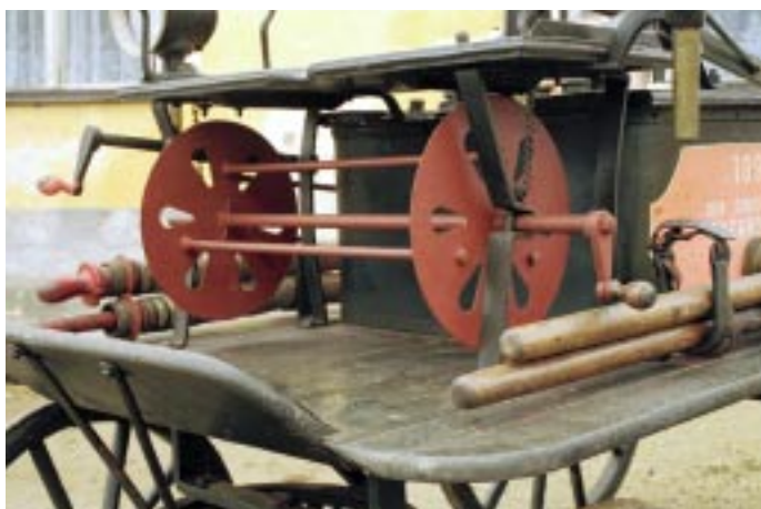
0490 - kovový ruční naviják na hadice umístěný pod přední sedačkou stříkačky
