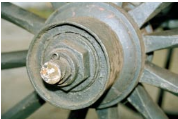
0488 - náboj kola a jeho zajištění proti samovolnému uvolnění maticí se závlačkou
