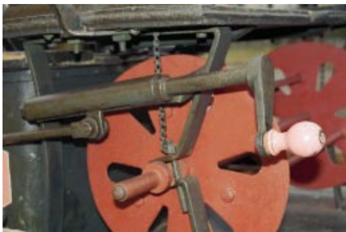
0490 - otočná páka ruční brzdy se zakrytým šroubením, třmenem a táhlo brzdy
